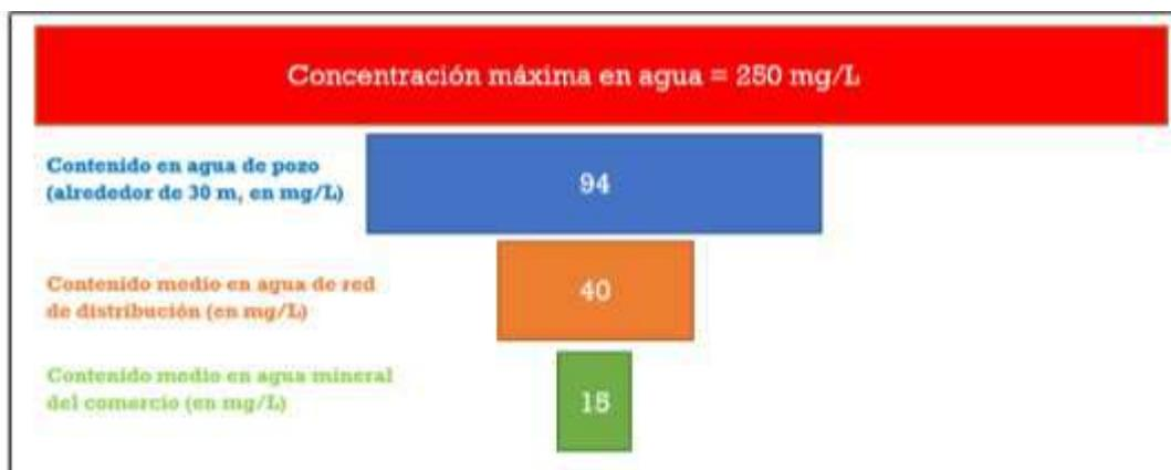
**Figura 2.** comparación del contenido de sulfato encontrado en el agua de perforación (aproximadamente a 30 metros) con los niveles de sulfato en el sistema de distribución y en el agua mineral.
